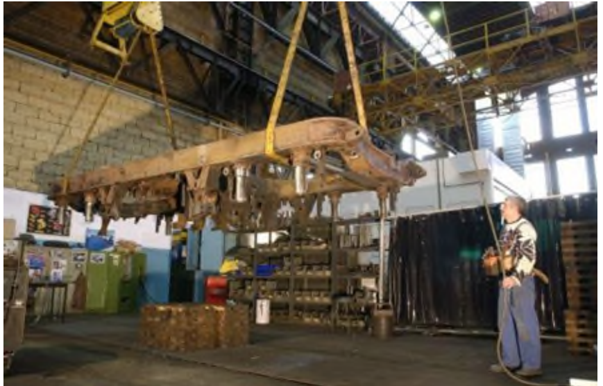
Bogie démonté pour une inspection approfondie à Salzinnes, 2004 (Réf. D2373-02)
